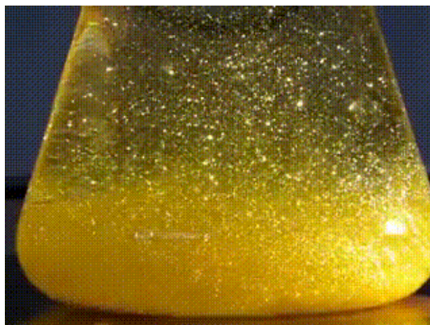
Jodek ołowiu(II) strącony w wysokiej temperaturze
